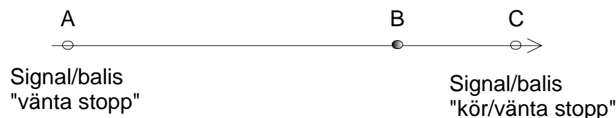
Figur 3. Punktvis uppdatering. När tåget kommer till punkt B ser föraren att den optiska signalen C visar kör, men ATC-systemet i fordonet har ännu inte fått den nya informationen.
